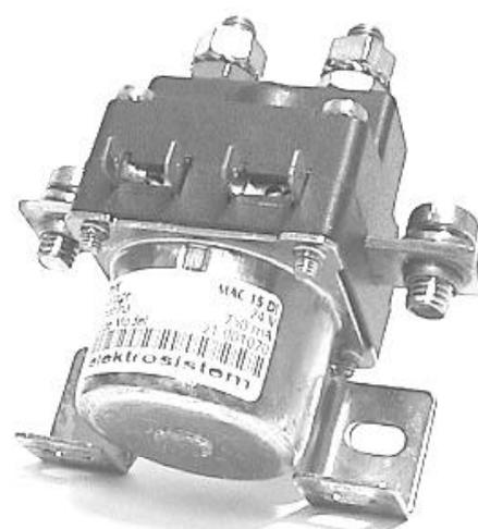
I contattori monoblocco della serie “MAC” sono caratterizzati da un forte potere d’interruzione e da ingombri estremamente contenuti. Il loro impiego è specifico per carichi in c.c. con tensioni d’esercizio fino a 96 Vcc (DC1).
